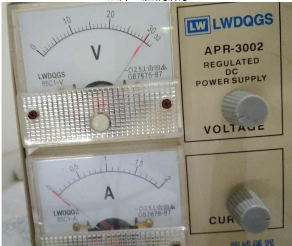
用调到 30V 的直流电源供电
