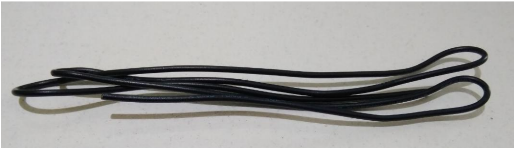
把这个粗铜线整平，然后把一端焊接在 L1 位置处
